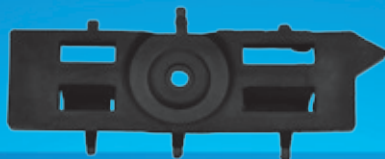
EK.1164 (LD) EK.1165 (LE) Suporte guia de para-choque traseiro GM Corsa Hatch 2005/2011
