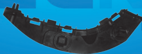
EK.1220 (LD) EK.1221 (LE) Suporte guia de para-choque dianteiro HONDA New Civic 2008/2012
